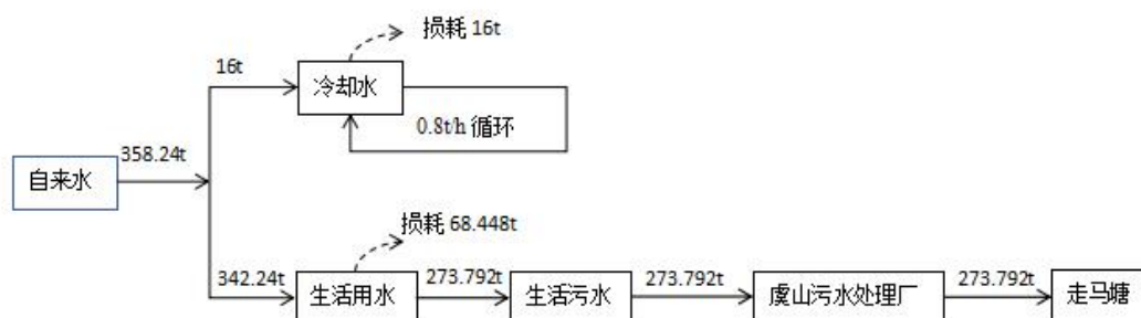
图2.7-1 本项目水平衡图 (t/a)
