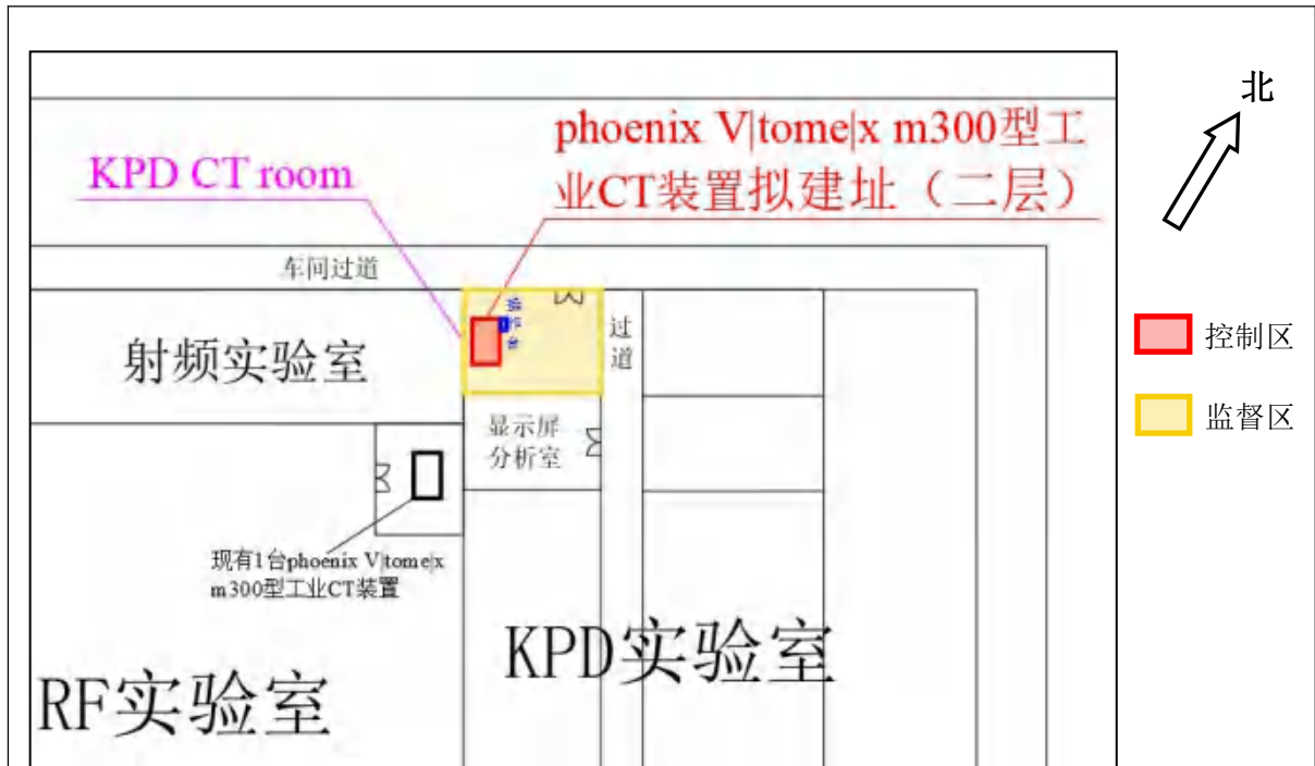
图 10-3 本项目 B1 栋 phoenix V|tome|x m300 型工业 CT 装置监督区及控制区示意图
